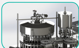
Tanque pulmão com controle de entrada de líquido.
