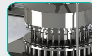
Exclusiva válvula para envase por gravidade possibilitando maior vazão.
