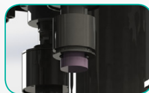
Castanha do tampador para cada modelo de tampa, podendo ser por pressão, rosca ou pinça.
